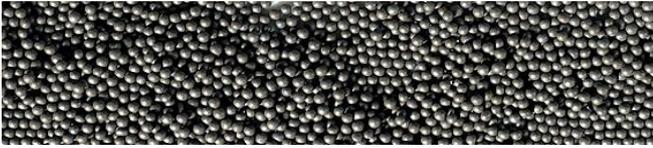
Das Elektro-Stahlguss-Strahlmittel gehört zur Gruppe der gegossenen, metallischen Strahlmittel. Es wird aus einer geeigneten schmelzflüssigen Stahlgusslegierung granuliert, thermisch nachbehandelt und in Kornklassen kugelig oder kantiger Kornformen mechanisch aufbereitet.
